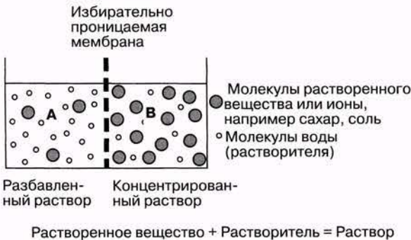
Рис. 5.18. Два раствора, разделенных избирательно проницаемой мембраной.
